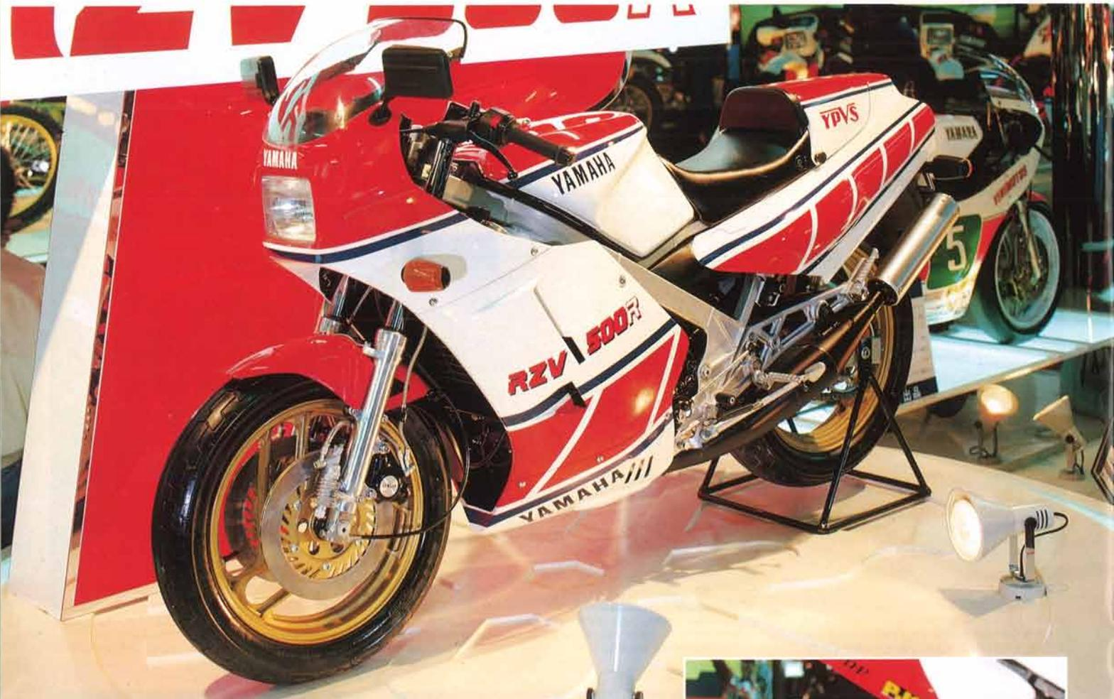
●水冷・2サイクル・V型4気筒・492cc●内径×行程56×50mm●圧縮比6.4:1●点火方式C.D.I.(電子進角式)●潤滑方式ヤマハオートループ●始動方式キック●変速機6速●全長2080mm●全幅670mm●全高1145mm●シート高780mm●軸間距離1375mm●最低地上高145mm●燃料タンク容量23ℓ●ブレーキ(前)ダブルディスク(後)シングルディスク●タイヤ(前)120/80-16V(後)130/80-18V
