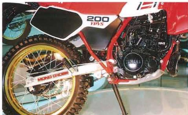
水冷・2サイクルエンジンには、マイクロコンピューター制御のY.P.V.S.を装備。ニューリンク式のモノ・サスはサブタンク付。リヤアームはアルミ製、リムもアルミの中空タイプを採用
