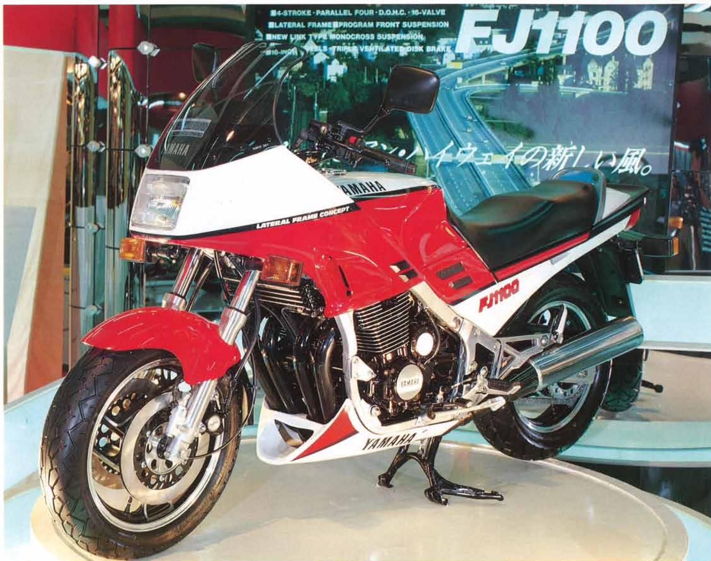
● 4サイクル・D.O.H.C. 並列4気筒・16バルブ・1097cc ● 内径×行程74×63.8mm ● 圧縮比9.5:1 ● 潤滑方式ウェットサンプ ● 点火方式T.C.I.(フルトランジスタ) ● 変速機5速 ● 高張力スチール角型チューブ・ラテラルフレーム ● 全長2230mm ● 全幅730mm ● 全高1230mm ● シート高780mm ● 軸間距離1490mm ● 最低地上高140mm ● 燃料タンク容量24.5ℓ ● タイヤ(前)120/80-16V(後)150/80-16V ● ブレーキ(前)ダブルディスク(後)シングルディスク
