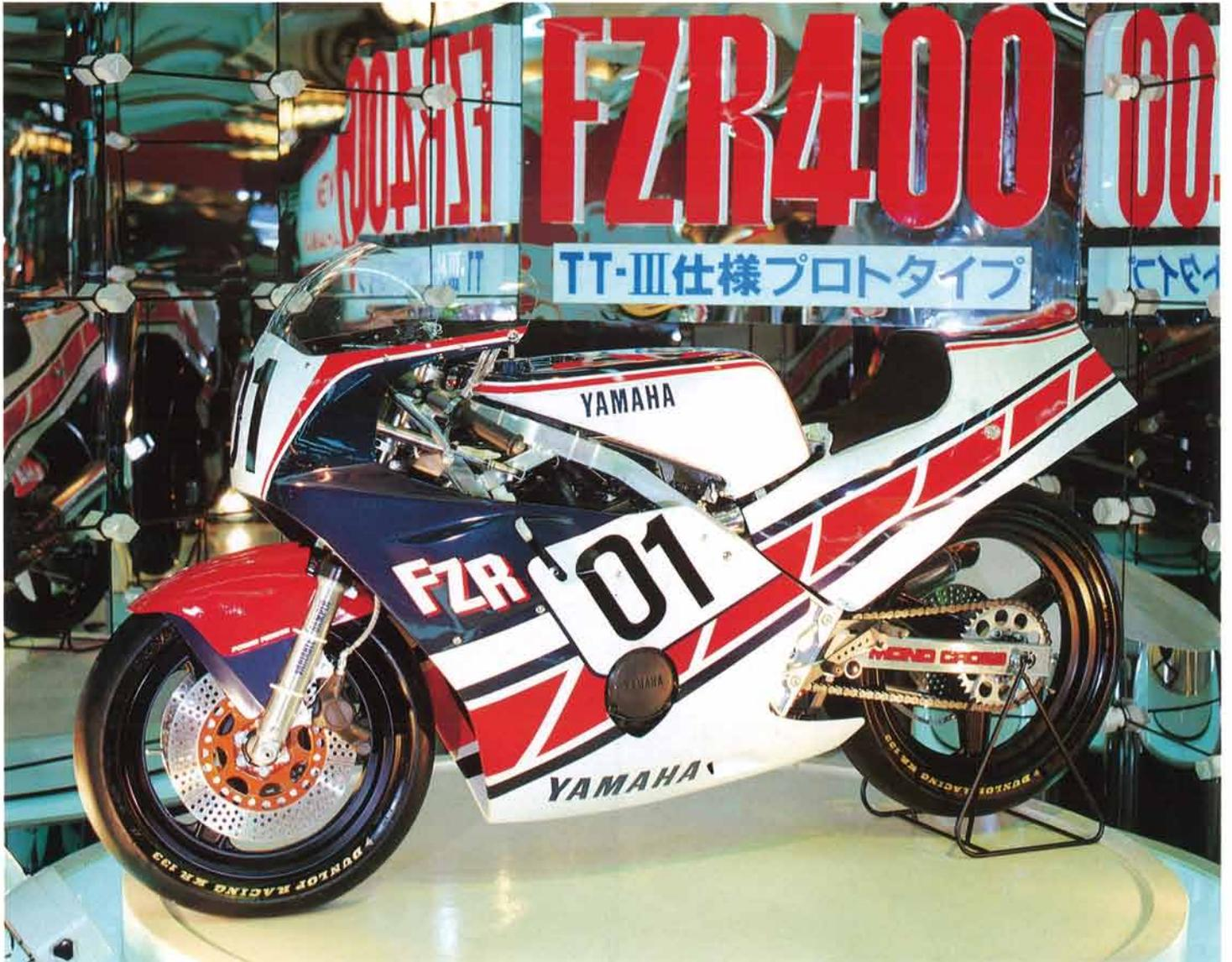
●水冷・4サイクル・DOHC・並列4気筒・16バルブ・398cc●最高出力62PS以上●点火方式フルトランジスタ●潤滑方式ウェットサンプ●変速機6速●タイヤ(前)16インチ(後)18インチ●ブレーキ(前)ダブルディスク(後)シングルディスク●車重138kg以下
