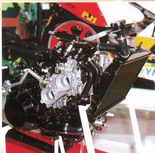
水冷・2サイクルエンジンにマイコン制御のY.P.V.S.を装備するなど最新のレーシングテクノロジーを盛り込んで新開発したDT200は、世界初登場。軽量ボディとエンジンパワーの理想的なマッチングが人気を集め、200ccトレール、という独自の市場が形成されつつある中で「早く国内発売を！」の声が集中した。
