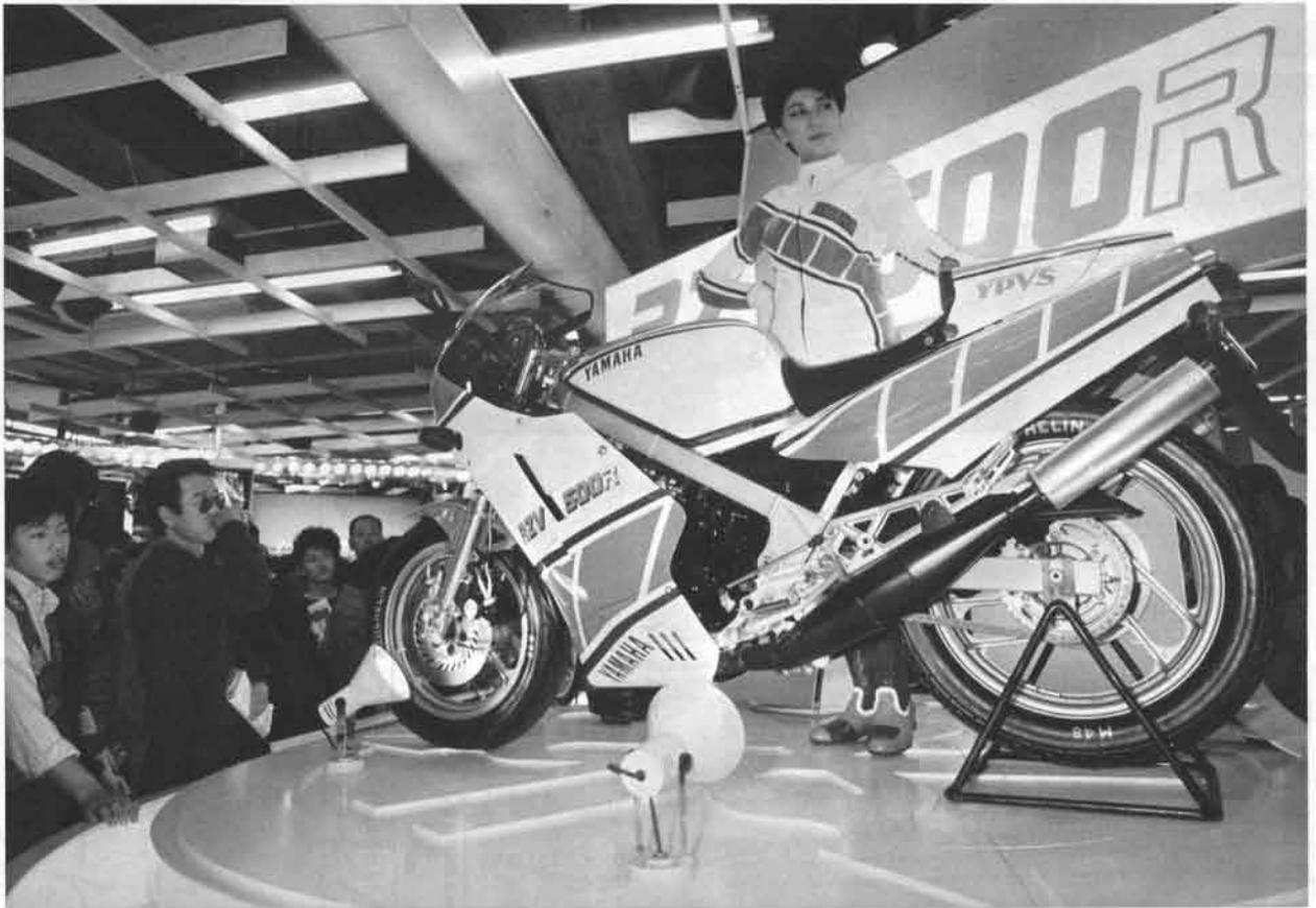
そして各排気ポートにはヤマハ独自の先進技術Y P V S (マイコン制御式) を装着。また潤滑はおなじみのヤマハオートループですが、これもオイルポンプの精度をアップすると同時にY P V S と連動させたニュータイプで、
