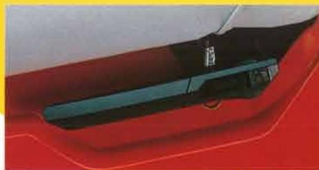
↑シート左側に設けたワイヤー式シートロック。これでガソリンタンクやバッテリーへのいたずらを防止します。またシートロックは、ヘルメットホルダーも兼用
