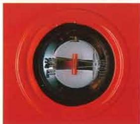
シート後方に設けたガソリン・メーター。残量がひと目でわかる安心設計
