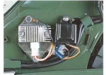
●アンダーボーンタイプでは初のレクチファイヤーレギュレーターを採用。バッテリー上がりやバッテリー液減少を大幅に改善
