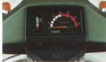
●昼夜を問わず見やすい大型メーターパネル。アンダーボーンタイプでは初めて燃料計をメーター内にセット。この燃料計は電気式で、しかもスイッチを切っても表示をつづける置針式
