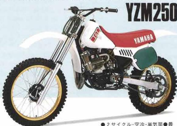
● 2サイクル・空冷・単気筒 ● 最高出力43PS以上/8250r.p.m.
