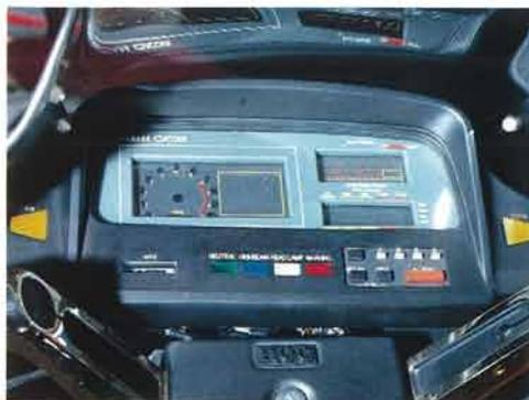
↑「XJ1100ターボ」には、世界初のモーターサイクル用ドライブ・コンピュータを組み込んだ「ヤマハ・サイコム・システム」を搭載
