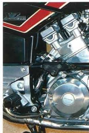
→新開発の70°Vツインは、水冷・DOHC、8バルブにY.I.C.S.とハイメカニズムの結晶
