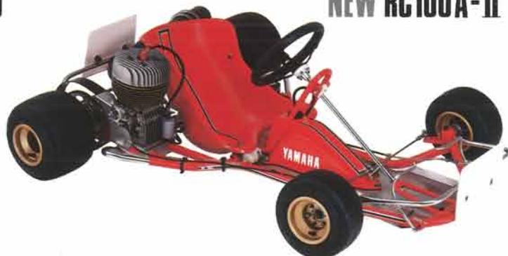
一方、頂点モデル「RC100A-II」は、高度なポテンシャルと抜群の耐久性を備えた新開発の「KT100AX」エンジンを新たに搭載。定評ある高剛性フレームとのマッチングによって実戦能力を大幅に高めたもの。パルスバイプレスの新設計ウォルボロキャブレターや3ピースホイールなどの新採用も新しい特徴。SLシリーズ戦Aクラスから国際レースまで幅広い活躍が期待される、カーター注目のニューマシンです。
