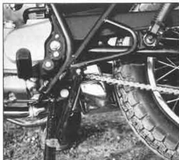
エンジン後方に設けられた大容量サブチャンバー。この側面にチェーン調整レベルが刻まれている。
