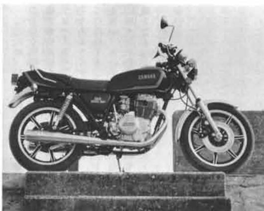
用。キャストホイール仕様車は前後輪ともチューブレスタイヤを装着させているほか、前輪の油圧式ディスクブレーキは、キャリパーをスイングタイプとしてパッドの交換を容易にし、整備性を高めています。
