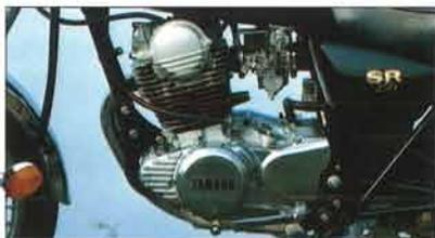
セルモーター、バルブサーを組み込みながらも、ご覧のとおりコンパクトでスリムな「SR250」のOHCエンジン。基本構成は、「XT250」と同一だが、こちらはフルトランジスタ点火、BS型キャブレターを採用
