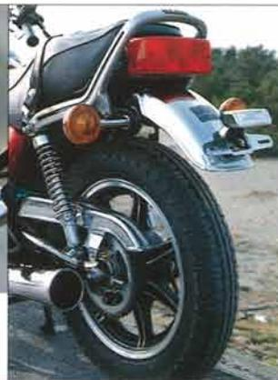
120/90-16とヤマハ車だけの小径幅広リヤタイヤ。シートとフィットした大型テールランプは安全性の高い2球式で、ライセンスランプとは別体、グラブバーも、ゴージャスなアルミ製。
