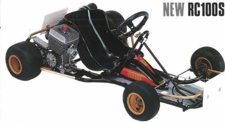
注目の「RC100S-VI」に加えて、今シーズンは「RC100S-D」も新登場します。「RC100S」のスペシャルモデルともいえるこの「RC100S-D」は、ブラックフレームに段付シャフト、マグネシウムホイール、「RC100A」と同一ステアリングホイール等の採用によって、一層のポテンシャルアップを計ったものです。
