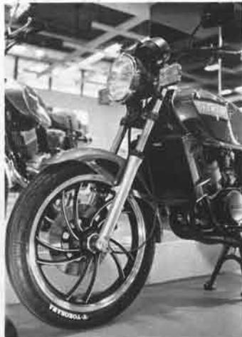
↑ニューパターンの3.00-18フロントタイヤはチューブレスで、キャストホイールも軽量な新型。170φのヘッドランプは、60W/55Wのハロゲンランプ
