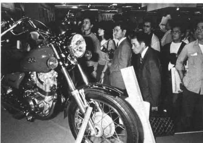
スポーツ「SR400SP/500SP」の機能と性能を、さらに「250cc」に合わせて追求した意欲的なニューモデル。735mmとらしく両足が接地する低いシート高、123kgと4サイクル125スポーツなみの軽い重量そしてスリムなボディ……など乗りやすさを徹底的に追求したもの。
