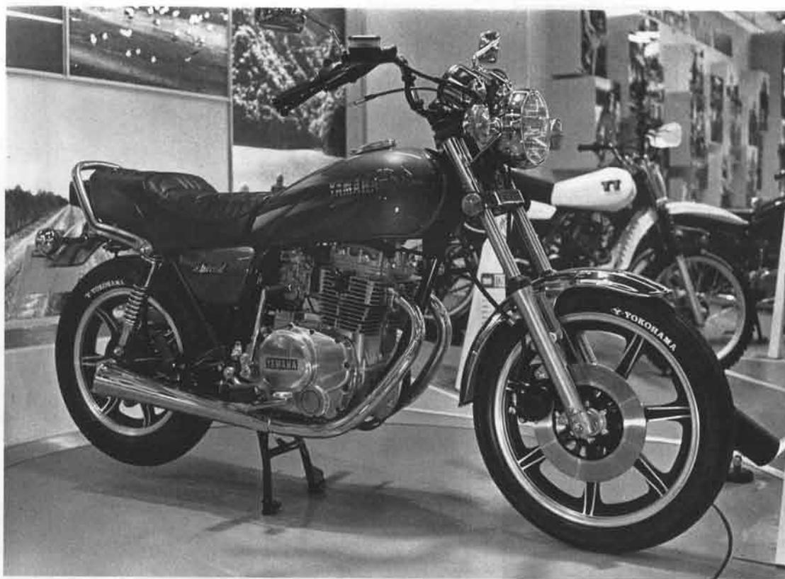
「XS650スペシャル」ゆずりのホースバック・スタイルに人気集中。「XS250スペシャル」●全長2070mm ●全巾870mm ●全高1140mm ●シート高770mm ●乾燥重量166kg ●燃料タンク容量14ℓ ●タイヤサイズ(前)3.00S18(後)120/90-16-63S、いずれもチューブレス
