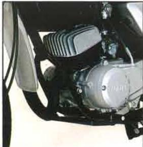
新設計のトルクインダクション・エンジン、大型シリンダー、シリンダヘッドに左右のケースカバーもデザイン一新。
