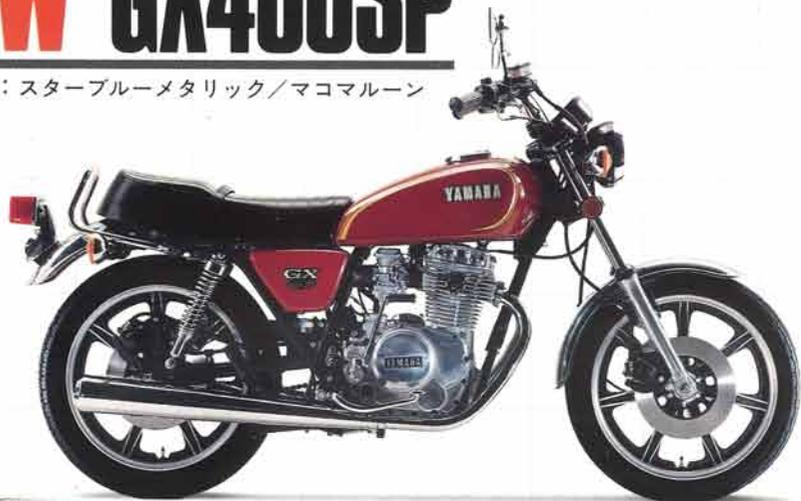
『GX400SP/GX250SP』は、キャストホイールの採用と合わせて、ティアドロップ型大型燃料タンクのグラフィックを一新。またハンドルレバーをパワーレバーに、左右のバックミラーも角型化するなど、『XS750/650スペシャル』に準じた細部の変更を施して、商品性を一段と高めたものです。
