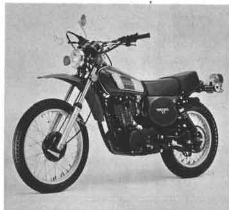
ル式にするなど車体の軽量化につとめ、4サイクル500ccながら重量わずか139kg(乾燥)の身軽さに仕上げました。しかし、いっぽうリアアーム軸受はモトクロッサーなみにニードルベアリングを採用、またドライブチェーンはリンク圧入方式のエンドレスタイプにするなど、行届いた設計を施しています。細かなところでは、ワイヤー類はブーツをつけてブレーキ同様に防塵防水式とし、ハンドルバーはゴムダンパー支持に、また左右のレバーはコーティング仕上げとしてあるほか、フラッシュャー支持も回転式としています。
