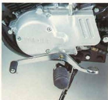
靴をいためないシーソー式のチェンジペダル
