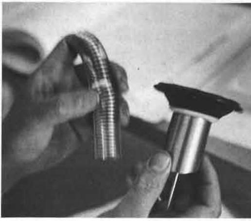
ダイヤフラムのついたバキュームピストンとバキュームピストンスプリング。TX500のCVキャブでは、ダイヤフラムのかわりにラピンスパッキンを使っている。バキュームピストンのスプリングつよさは重要なポイントの一つであり、これを伸ばしてみたりするのは厳禁。なおキャブレターの各部品はそれぞれ交換部品の用意がある。
