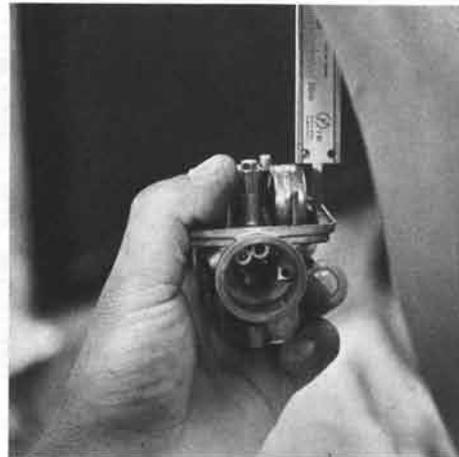
いくと薄くなり、戻していくと濃くなる。(点検箇所)パイロットジェットをつまみ、ゆるみ。ブリードパイプをつまみ。パイロットスクリーンの調整不良。
