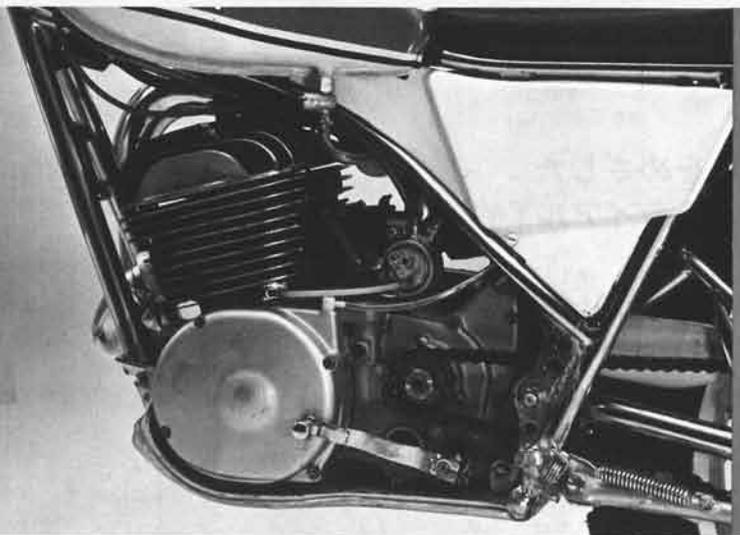
クランク室の圧力変動でダイヤフラムポンプを作動、全回転域で適切な燃料供給を行なう新技術を投入したエンジン
