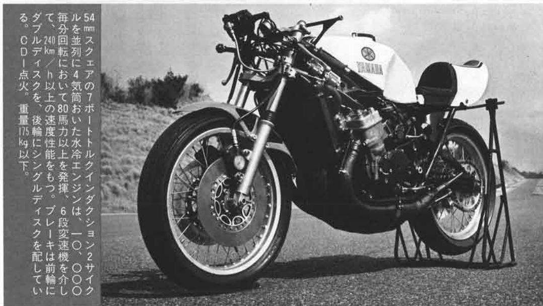
54mmスクエアの7ポートトルクインダクション2サイクルを並列に4気筒おいた水冷エンジンは、一〇、〇〇〇毎分回転において80馬力以上を發揮、6段変速機を介して、240km/h以上の速度性能をもつ。ブレーキは前輪にダブルディスクを、後輪にシングルディスクを配している。C.D.I点火。重量175kg以下。
