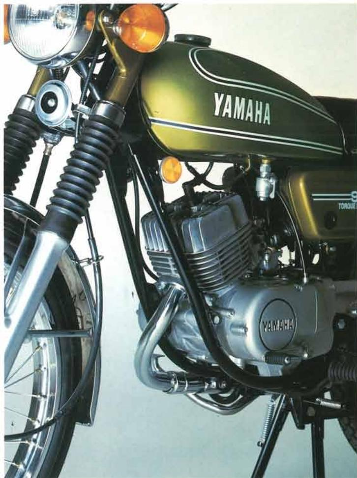
がっしりした構成のダブルクレードル型フレーム
