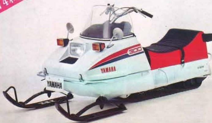
ヤマハスノーモビル発売以来5シーズンの実績をもとに開発した小型軽量の汎用型。全長は2,430mm、重量わずか150kg。1,500cc級のライトバンにかかる積みこめます。巾23mm増しのスキーはすぐれた直進性を保ち、15ℓセンター方式の燃料タンク配置とあいまって抜群の走行安定性を発揮します。一段と豪華になったメーターパネルまわりをはじめ、より静かな排気消音対策など、充実した装備も大きなセールスポイントとなるものです。
