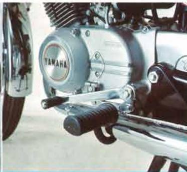
リンク機構式のチェンジペダル
