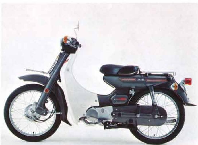
■全長1845mm 全巾 645mm 全高1010mm 軸間距離1180mm 最低地上高135mm 重量80kg
