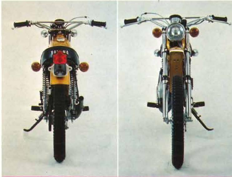
スリムな車体構成。マフラーはダウン型だが車体巾はせまい。フートレストは可動型
