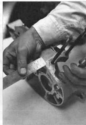
④ このとき、平均に削り落とすと掃気ポートにつながる切欠きを損なう恐れがあるので、この部分は6mmほど突出させておく。またオイルハウジングの止め孔5コを利用して6mmのタップをたてる。これは第3気筒のクランクケースとの結合を行なうためのもので、このほか後部に適宜に2カ所ほど設けることが肝要。
