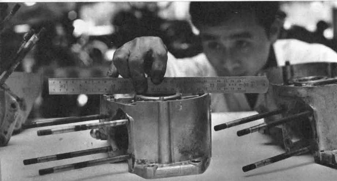
⑤ 第3気筒のクランクケースは第2気筒のクランクケースの突出しを考慮しながらオイルシールハウジングと面一(つらいつ)に削る。ただし第4気筒のクランクケースとの合わせ面には手をつける必要はない。
