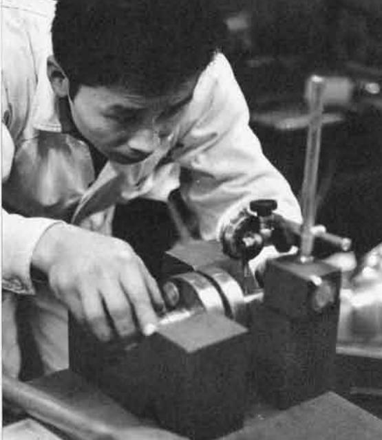
⑬ 組立ては最初の2気筒をまず手がけるが、これは通常のエンジン組立てと変わらない。各クランクのバランスをとり…
