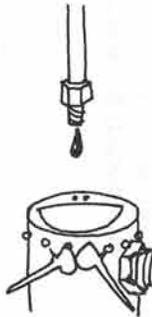
もガス欠と同じことになります。雨天の燃料補給のときに雨水が入ったり、また燃料パイプがシリンダ附近に垂れさがりエンジンの熱の影響をうけて燃料パイプ内で蒸気化している（このような現象がベーパーロックといい、ほとんどのよい
