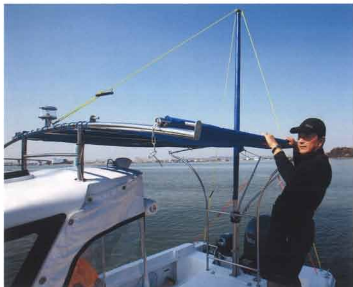
谷本さんのF.A.S.T.26は、岡山マリン・オリジナルのキャンバストップを装備。写真のように片舷ずつ巻き上げて収納することができ、走行時もバタつかないのが特長
