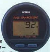
燃料流量はリットル/h、gph(ガロン)の選択が可能。燃料効率率はスピードメーターを連結することによってkm/hの表示が可能です。2基掛け速度同調器は回転数を同調させる際の参考用として表示します。水量警告灯は油水分離器(オプション)を設置した際の分離器内の水分を検知、表示します。(センサー装備の場合のみ作動)
