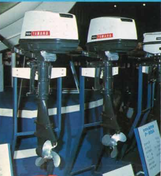
遠出にも安心な多目的エンジンで人気があるP-125A 6馬力。別タンクで灯油も使える。
