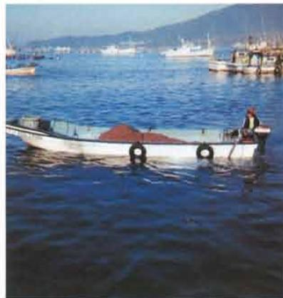
の魚をバラ積みして運搬するやり方ですが、W125BF(特機)はデッキを約二十センチ低くし、バウとトランサムをやや高くしました。約二トンの餌を積むことができます。船外機はYAMAHA 9.9SULを使用。木船にくらべてスピードが出て燃費もよく、また水洗いできて掃除のしやすい点が漁家に歓迎されています。
