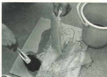
②ポリエステル樹脂に硬化剤を添加(夏0.25%冬0.5%)よく混合し、ガラス繊維のマットにたっぷりしみこませる。
