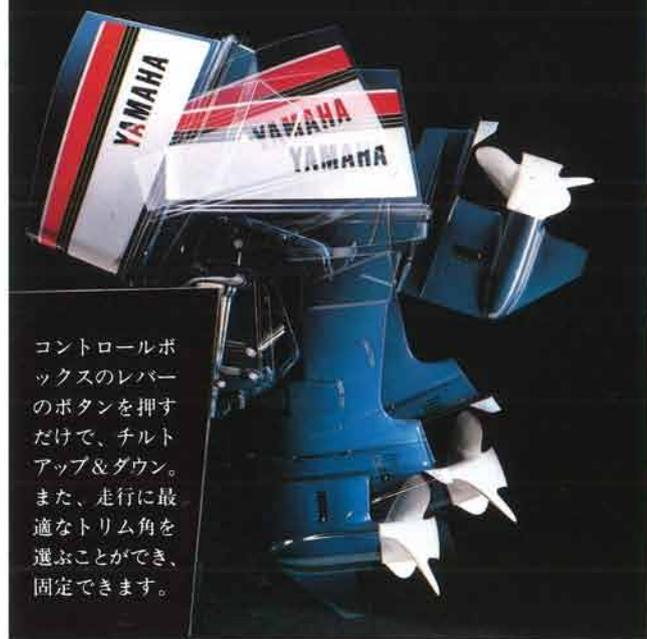
コントロールボックスのレバーのボタンを押すだけで、チルトアップ&ダウン。また、走行に最適なトリム角を選ぶことができ、固定できます。
