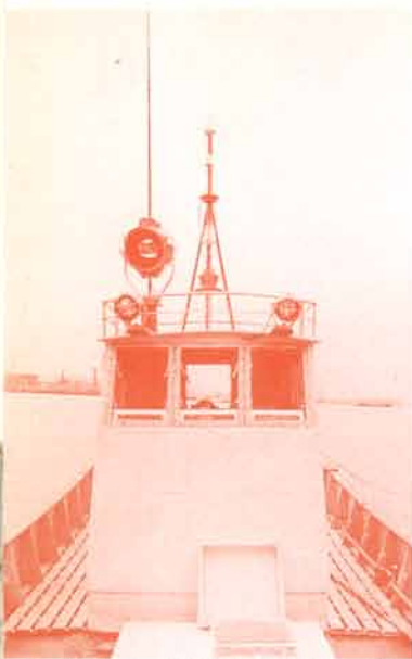
操舵室の正面 上部にはアンテナとともに夜間作業用のライトがものしくならぶ
