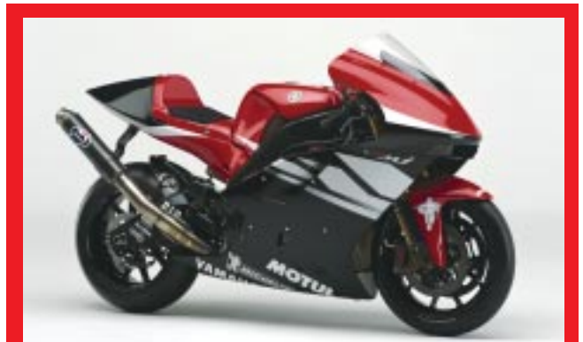
OWN3(2003年) 燃料供給がFIとなる。前年型のエンジンブレーキ制御システムはICS(アイドル・コントロール・システム)へと変更。4気筒のうち2気筒のスロットルバルブの開閉をECU経由のサーボモーターでアジャストする仕組みだった。
