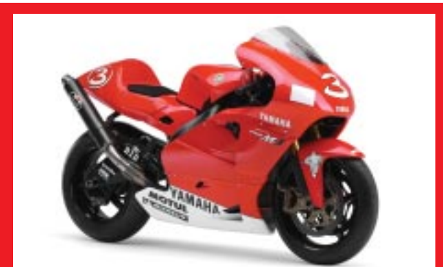
OWM1(2002年) MotoGP元年を走った初代型。当初は実績あるYZR500系の車体をベースにフレームが開発されたが、シリーズ序盤に4ストローク専用フレームを採用。エンジンブレーキ制御システム搭載が特徴。
