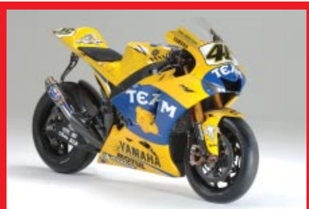
OWR3(2006年)4気筒中の2気筒分について電子制御を行っていた従来の「2×2のICSシステム」に替え、4気筒全てのスロットルバルブ作動を電子制御で行うフライ・バイ・ワイヤーシステムを投入。
