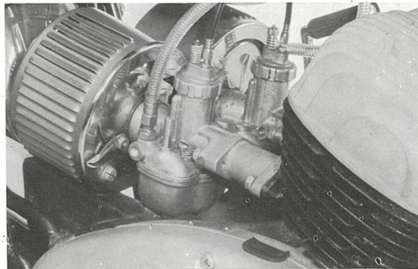
二個の気化器は気筒に直結され流路の抵抗が少ないので
