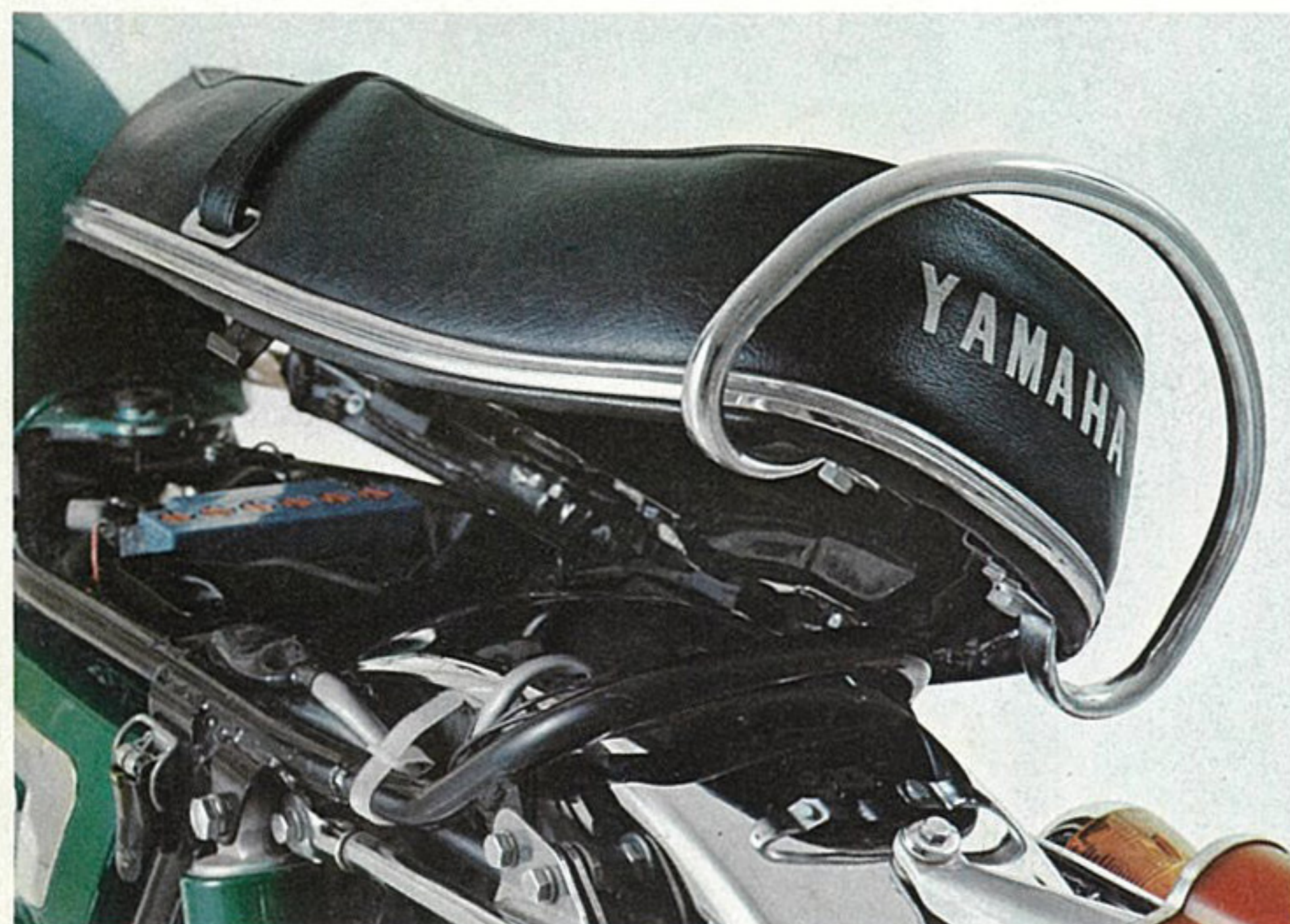
● 画期的な整備性を生んだ、ワンタッチ開閉のできる横開き式シート。
