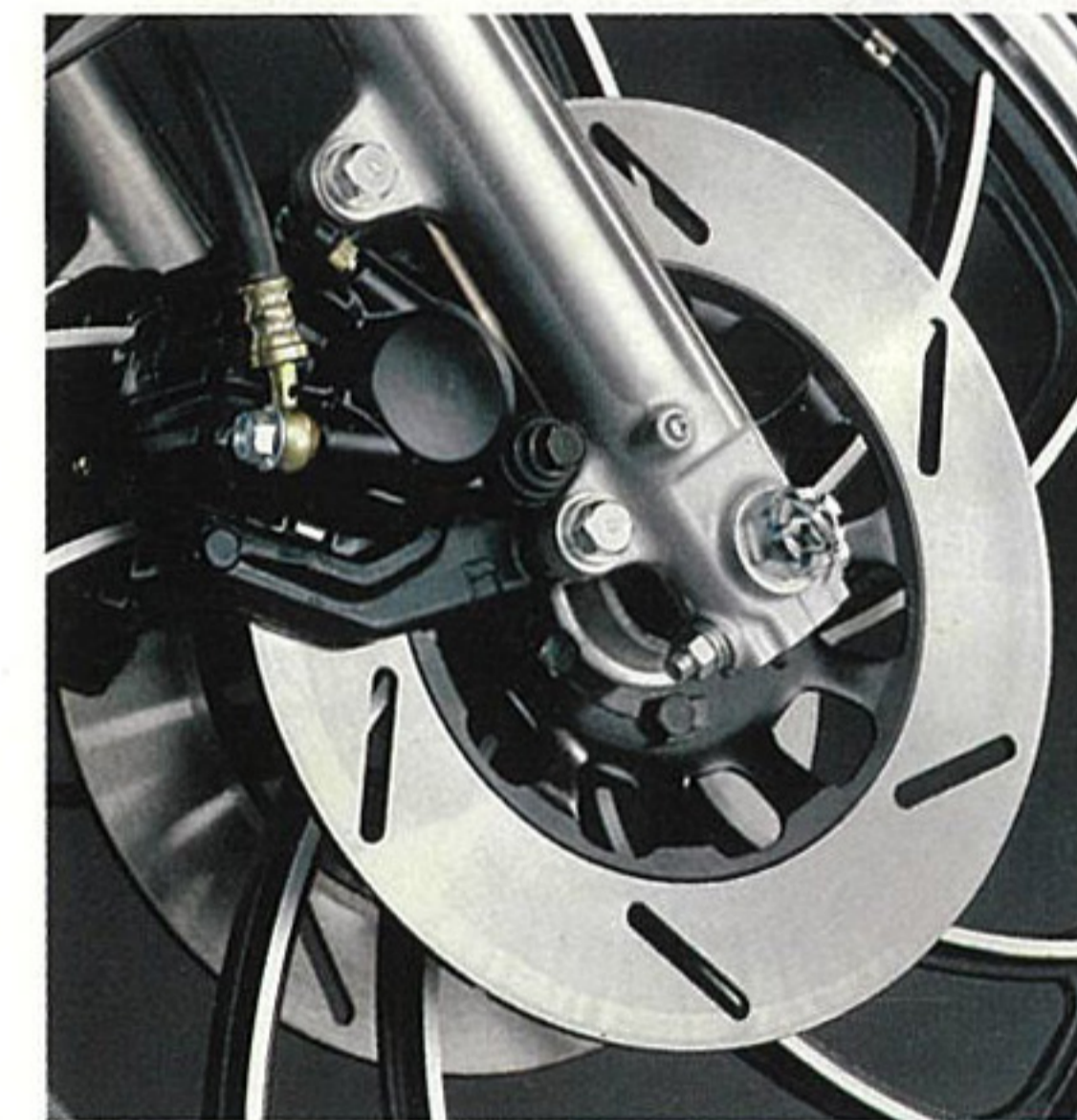
スーパーファイターの走りを支えるブレーキシテム。フロントには油圧式ダブルディスク採用。クラス最高のポテンシャルを持つスーパースポーツ
