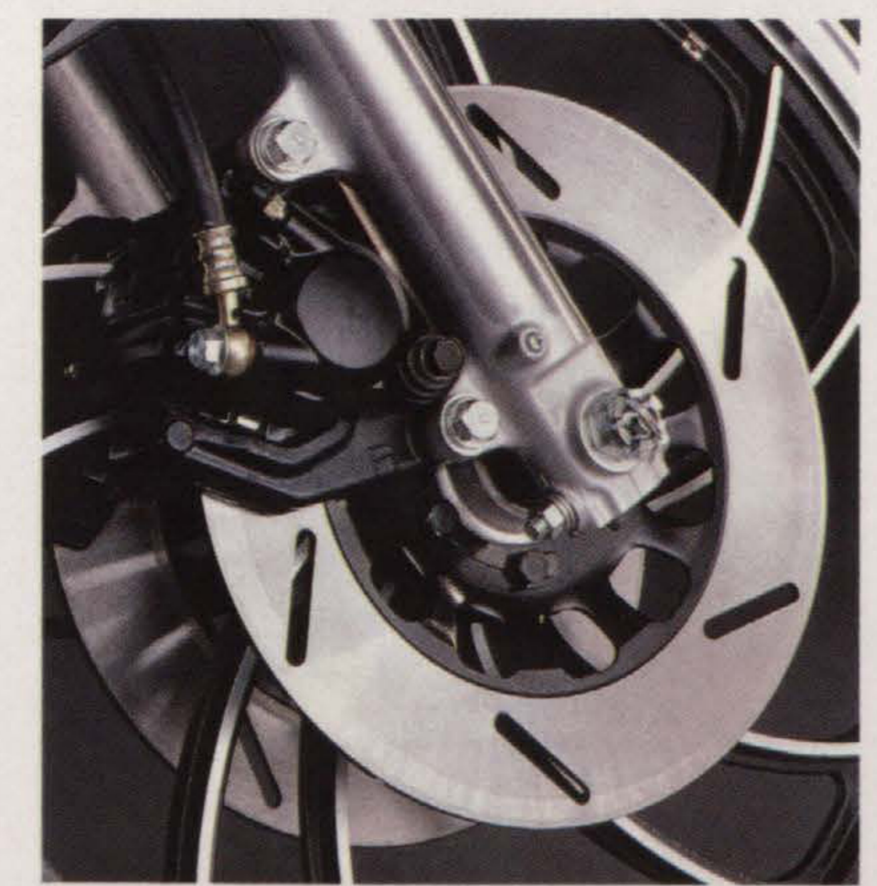
スーパーファイターの走りを支えるブレーキシステム。フロントには油圧式ダブルディスク採用。クラス最高のポテンシャルを持つスーパースポーツ
