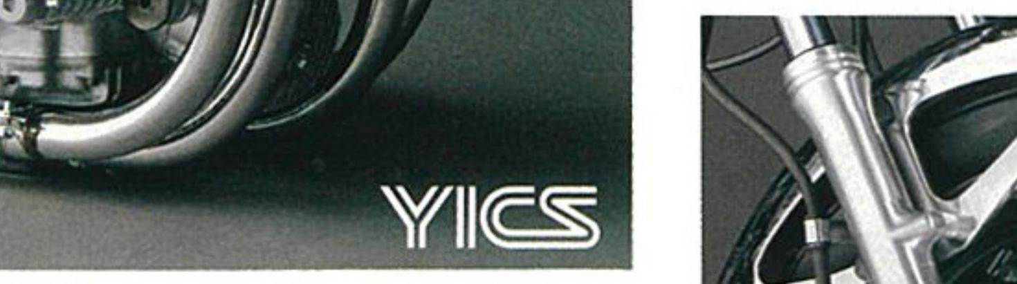
低いエキゾーストノートは、ひとクラス上の厚みあるサウンドといえます。また左右2本のマフラーは深いバンク角を実現するために、後方へステップアップ。コーナリング時の接地への不安を、根本からなくした排気システムです。
