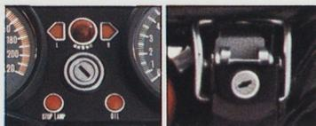
操作のしやすい両面キー。メインスイッチ、タンクキャップ、ハンドルロック、シートロックが一つのキーでできます。
