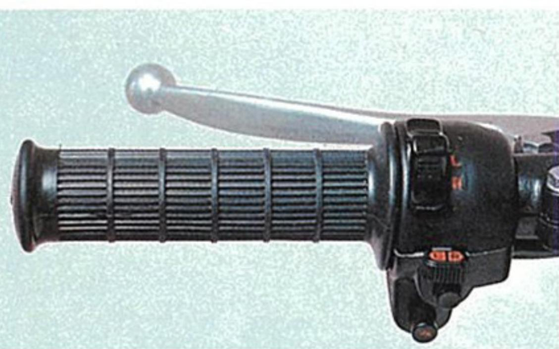
ボタンを押すとヘッドライトが点灯するパッシングライト。高速走行に欠かせない装備です。メーターパネルにはブレーキランプ断線警告灯も組みこみました。
