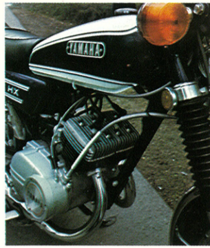
●ネジレ剛性の大きな高張力鋼管ダイヤモンドフレーム。コーナーでとくに威力を発揮。
