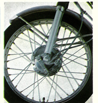
●キキが確実。雨中走行もラクな完全防塵防水ブレーキ。
