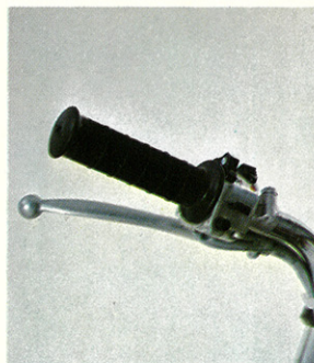
●スイッチ類はすべて左手に集中。操作のしやすさは無類。
