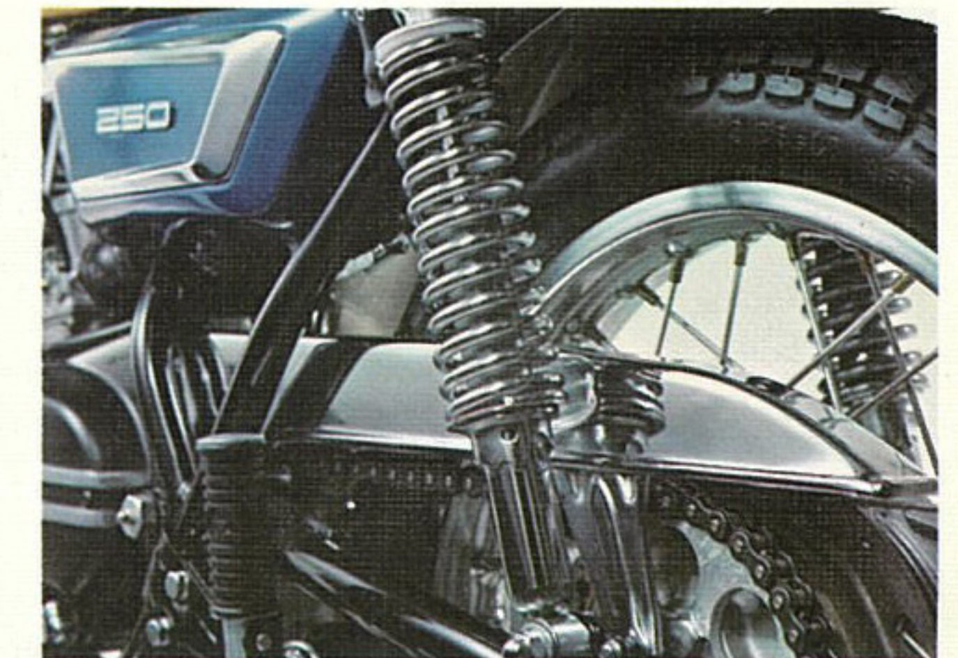
●軽快なデザインのスプリング式リヤクッション。長いストロークがフロントフォークとあいまって抜群の乗車感を約束。
