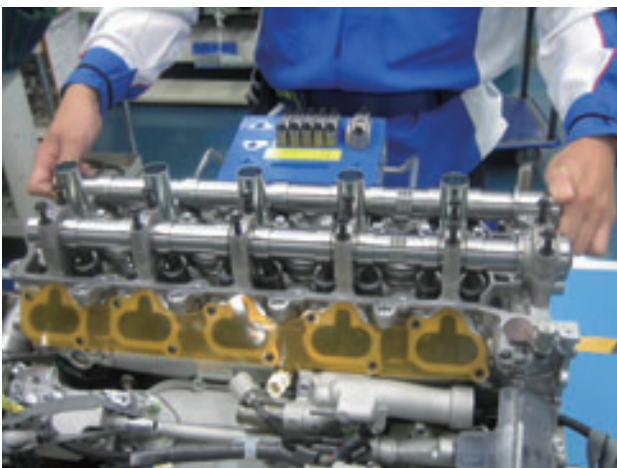
図10 ダミーカムシャフトによる芯出し
