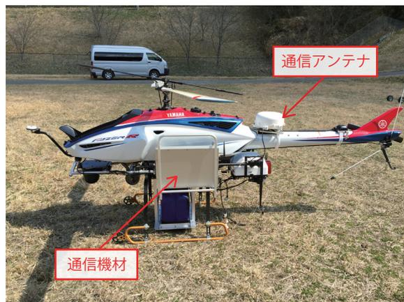
図2 衛星通信機を搭載したFAZER R G2
