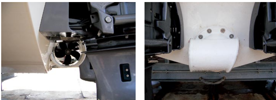
図12 船尾スラスタ(正面と側面)
