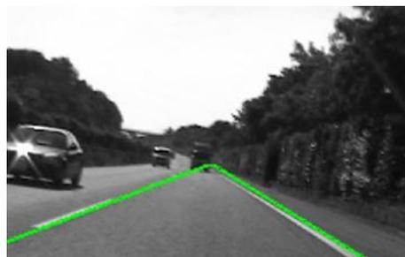
図6 後方の車線検出例
