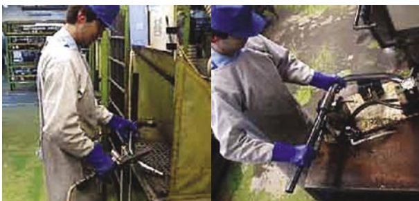
図5 曲げ傷修正工程
