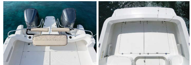
図8 SR320FBとSC-30eXの後部デッキ形状の違い
