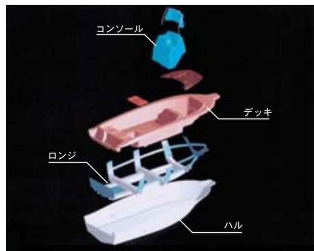
図6 構造分解図
