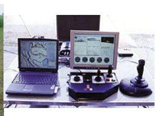
地上局 (地上管制装置)
