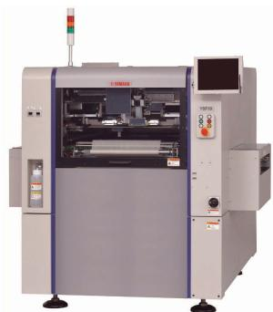
印刷工程において最も工数を要する段取り替え作業を全自動化するため、新開発されたモデル
