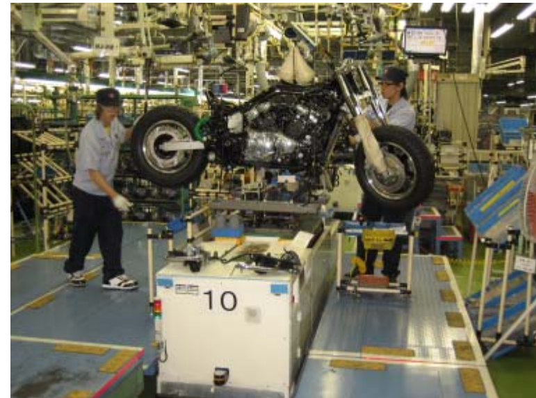
自動搬送車 (AGV) を使って組立
