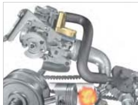
※YMJET-FI=Yamaha Mixture Jet-Fuel Injection。主通路とは別に設けた副通路からのエアアシストを行い噴射燃料と空気を効率的に混合させ、実用域での燃費向上に貢献するFIシステム。
