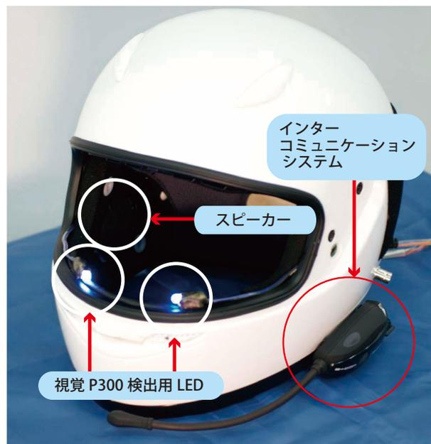
図2 インターコミュニケーションシステムを設置した実験用ヘルメット
