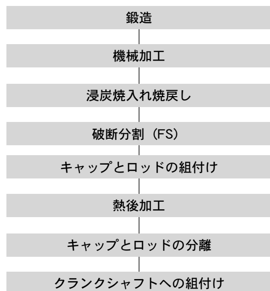
図3 FS浸炭コンロッドの製造工程
