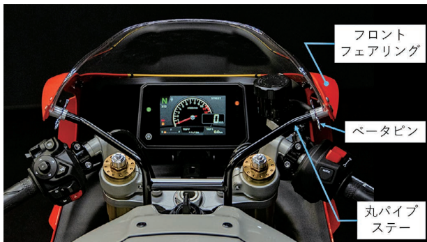
図7 コックピット周り
