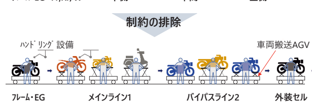
図3 設備制約を排除した汎用組立ライン
