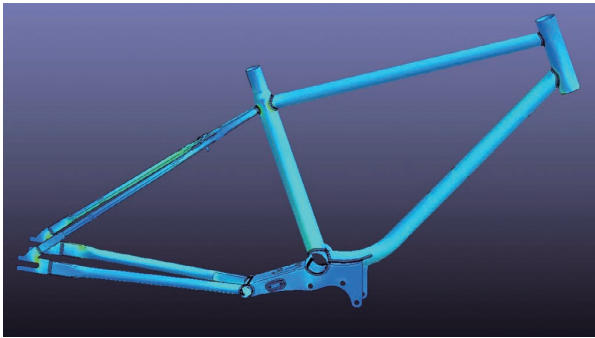
図2 フレームの応力解析モデル
