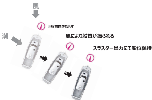
図6 e-COMPASS 設定時 船の動き
