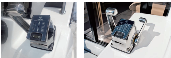
図2 微速操船装置 FSR(左)/SSR(右)
