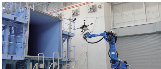
図5 機体抵抗試験の様子
