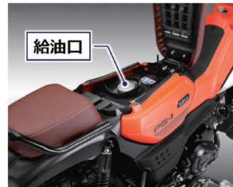
図6 給油のしやすさと積載性を考慮したシート構造
