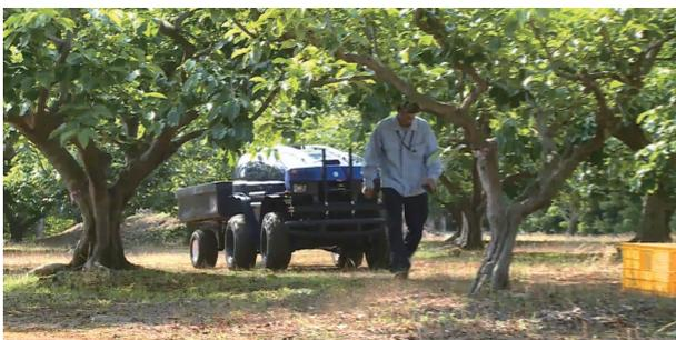
図17 LiDAR を用いた人追従
