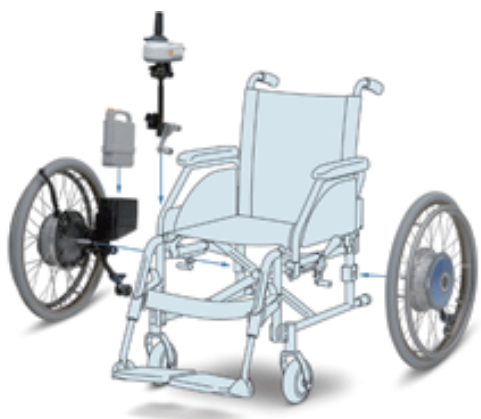
図3 車いす用電動化ユニットの構造 [3]
