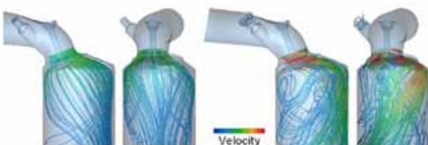
図5 YMJ-FIの効果(副通路有り無しによる筒内流動の差)
